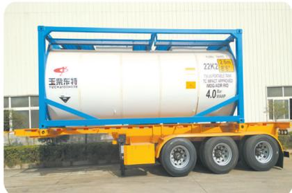
▲ 20 英尺 T14 腐蚀品保温钢衬塑罐式集装箱
